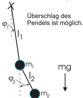
Gegeben sei ein Doppelpendel (siehe Zeichnung) bestehend aus zwei masselosen Stangen der Länge  $l_1$  und  $l_2$ , an deren Enden die Massen  $m_1$  und  $m_2$  angebracht sind. Das erste Pendel sei an einem fixen Punkt befestigt, während das zweite Pendel an der Spitze des ersten hängt. Bitte verwenden Sie die in der Zeichnung benutzten Bezeichnungen.
