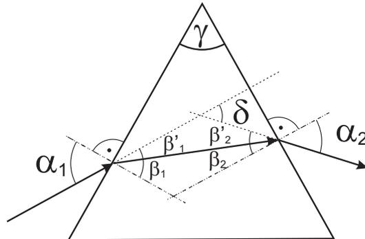
Abbildung 1: Strahlenverlauf in einem Glasprisma
