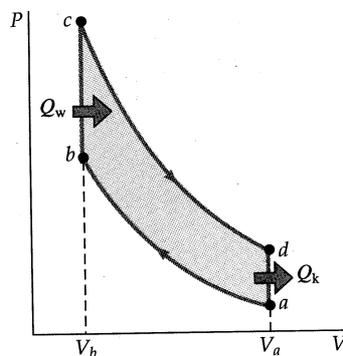
adiabatisch komprimiert bis b. Nach der Zündung heizt sich das Gas durch die explosionsartige Verbrennung auf und bei konstantem Volumen  $V_b$  erhöht sich sein Druck von b auf c. Dabei wird die Wärme  $Q_w$  zugeführt. Beim Arbeitstakt von c nach d wird adiabatisch expandiert. Während der Abkühlung bei konstantem Volumen (von d nach a) wird die Wärme  $|Q_k|$  abgegeben. Dies entspricht dem Auspufftakt und dem Ansaugen des neuen Gemisches.
