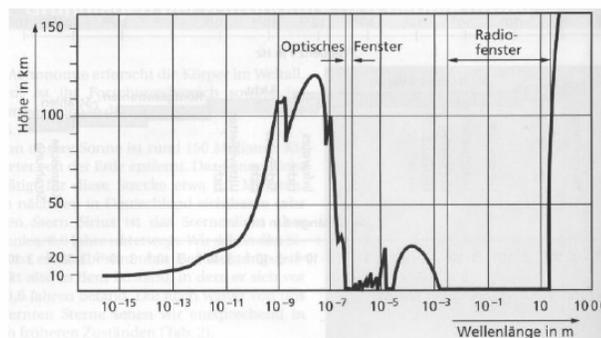
Absorption elektromagnetischer Strahlung verschiedener Wellenlängen durch die Erdatmosphäre. Die Kurve gibt diejenige Höhe an, bei der die einfallende Strahlung auf 10 % ihrer ursprünglichen Intensität abgefallen ist.
