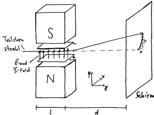
Zeigen Sie, dass von einem Strahl polyenergetischer Teilchen identischer Masse  $m$  (Ladung  $e$ ) auf dem Schirm eine Parabel  $y = Ax^2$  abgebildet wird. Nehmen Sie im Feld eine Geschwindigkeit  $v \approx v_z = \text{const.}$  an, berechnen Sie damit die Ablenkungen  $x(v)$  und  $y(v)$  am Schirm und eliminieren Sie  $v$ . Das Ergebnis lautet:
