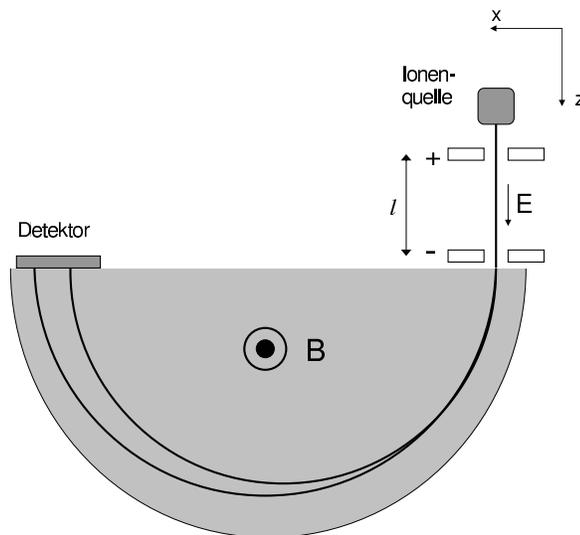
In der Vorlesung haben Sie einen Massenspektrometere Aufbau kennengelernt, in dem Ionen (einfach geladen) zunächst in einem elektrischen Feld beschleunigt werden (bei Eintritt haben sie Geschwindigkeit Null) und anschließend in einem dazu senkrecht stehenden magnetischen Feld Halbkreisbahnen durchlaufen. Leiten Sie her, dass der Radius solch einer Halbkreisbahn
